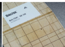
BALTEK® SB.100GPs (Version pour infusion) Panneaux poncés. Perforation (diamètre 2mm, 50 mm distance) et rainures (0.7 mm largeur, 2.5 mm profondeur) et distance 20 mm sur les deux côtés, avec coupe dans une seule direction par l'épaisseur, distance 50 mm avec tissu.
